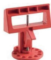
Condamnateur grand modèle : tourner la vis dans la poignée du disjoncteur et ajouter un ou plusieurs cadenas ainsi qu'une étiquette de signalisation. Mise en place aisée sans outil.
