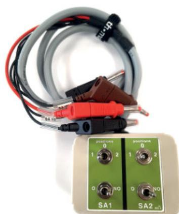
Boîtier de test sectionneur SA1/SA2.
